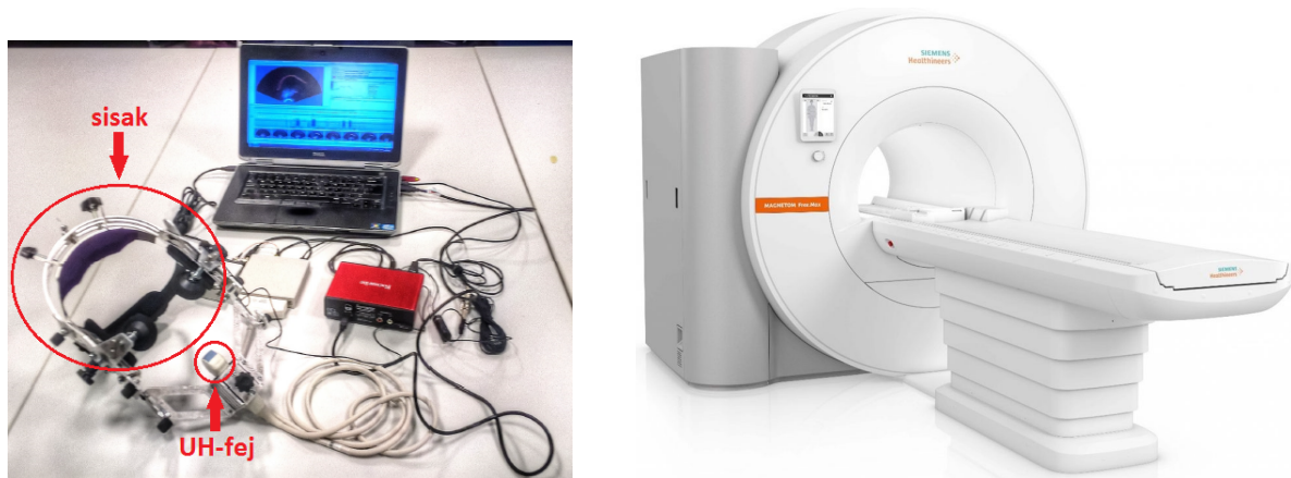
2.3. ábra. Dinamikus audiovizuális beszéd felvételek készítésére alkalmas UH-készülék (balra) és MRI-berendezés (jobbra). [56]
